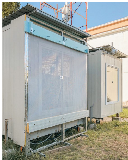
Fig. 1 - Le test cell GEMINI 1 e 2 del laboratorio RIAS del DADI per valutazione sperimentale delle prestazioni termiche, acustiche e visive della rete plastica Soltis FT381 nel progetto WALLED (sulla sinistra GEMINI 1, equipaggiata con il sistema per facciata a doppia pelle, mentre sulla destra GEMINI 2, utilizzata come riferimento) | The test cells GEMINI 1 and 2 of the RIAS laboratory of DADI for the experimental evaluation of thermal, acoustic and visual performance of the Soltis FT381 plastic mesh during the WALLED project (on the left GEMINI 1, equipped with the second skin façade system, while on the right GEMINI 2, used as a reference).
