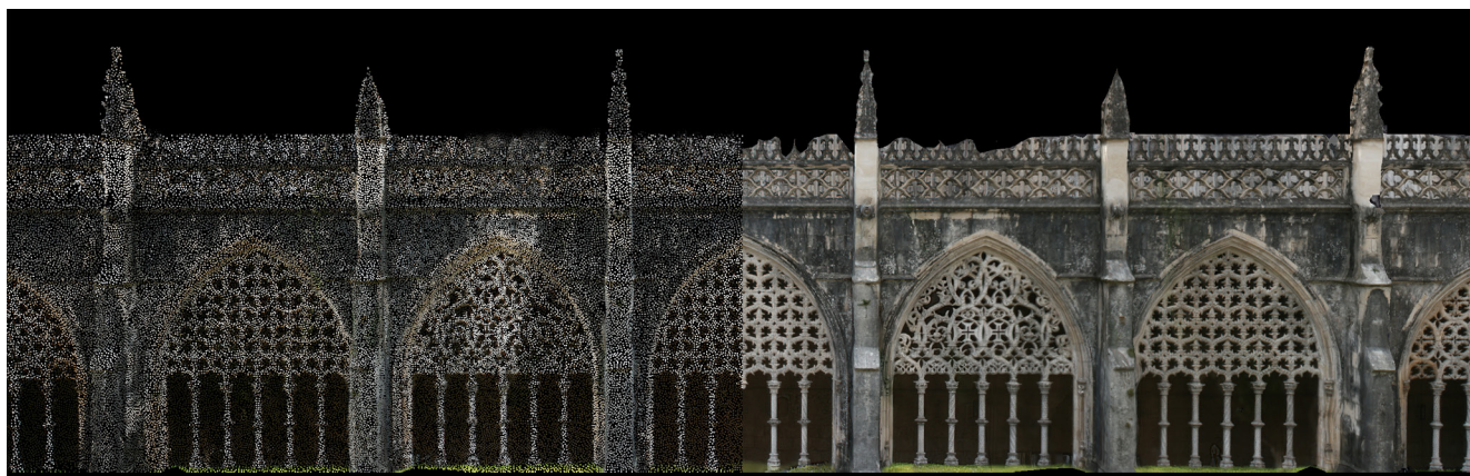
Fig. 8 - Chiostro di D. João I del Monastero di Batalha. Nuvola di punti densa e mesh texturizzata del prospetto esterno del Chiostro | Cloister of D. João I of the Monastery of Batalha. Dense point cloud and textured mesh of the exterior elevation of the Cloister.
