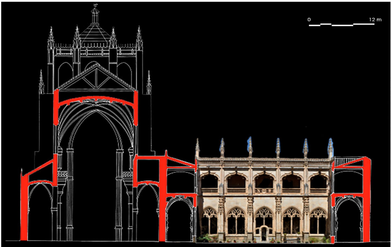
Fig. 10 - Il Monastero di San Juan de Los Reyes a Toledo. Sezione trasversale sulla chiesa e del chiostro | The Monastery of San Juan de Los Reyes in Toledo. Cross-section of the church and cloister.
