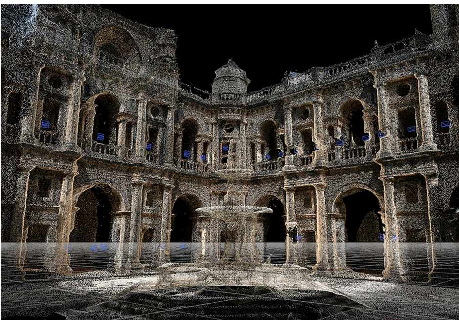
Fig. 7 - Chiostro Principale o de D. João III del Convento dell'Ordine di Cristo. Nuvola di punti densa, ottenuta attraverso il processo di fotogrammetria aerea e l'identificazione dei punti di acquisizione | Main Cloister or de D. João III of the Convent of the Order of Christ. Dense point cloud obtained through the process of aerial photogrammetry and identification of acquisition points.
