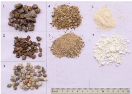
Fig. 6- Inerti: 1. Pietrisco di porfido lavato 8/15mm; 2. Graniglia di porfido lavato 4/8mm; 3. Ghiaietto lavato 7/10mm; 4. Sabbia 0/6 mm; 5. Sabbia 0/4 mm; 6. Polvere di marmo 00 (Bellamoli, Ala TN); 7. Calcinarioli (M. Mazzocchi, 2023).
