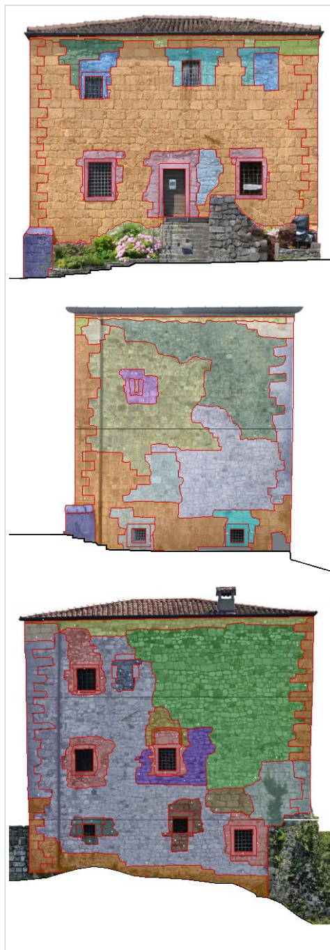
Fig. 3- Abbazia di Moggio (provincia di Udine, Italia). Mappatura delle stratigrafie dei prospetti Est, Nord e Ovest della cosiddetta 'Torre delle ex prigioni' (Elaborazione degli autori, 2024).
