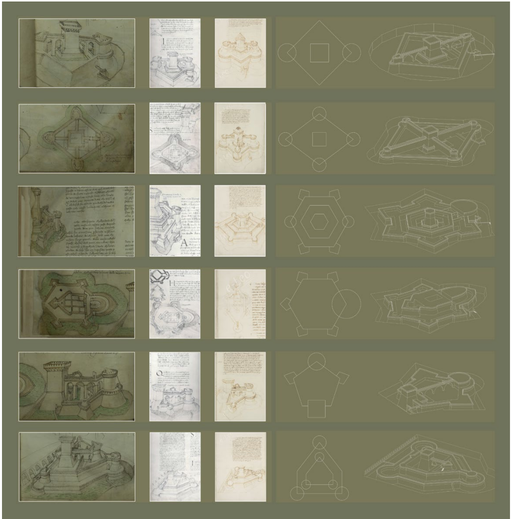
Fig. 7- Esempi di ricostruzioni di fortificazioni del Codice a partire dallo schema planimetrico e confronti con gli esempi disegnati negli altri codici.
