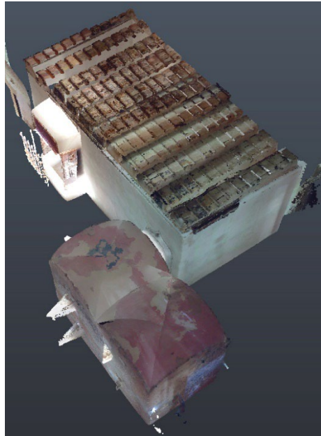
Fig. 12- Perspectiva extraída de la nube de puntos del escaneo 3D de parte de la planta primera. Se aprecia una de las salas con techumbre de madera y otra, en la torre nortoriental, con bóveda tabicada aristada (Conxeta Romani, 2024).
