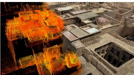
Fig. 6- Banca dati 3D, l'acquisizione multiscale ha reso possibile la comprensione morfometrica delle complessità architettoniche del villaggio e in particolare della Kasbah (elaborazione degli autori, 2024).
