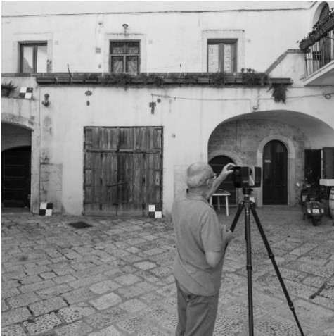
Fig. 9- Operazioni di rilievo laser scanner (foto dell'autore, 2024).
