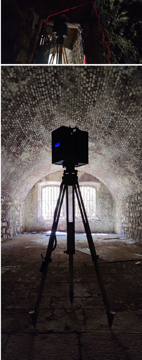
Fig. 2- L'unità laser scanner 3D in opera al Forte di Montalbano (foto degli autori, 2024).
