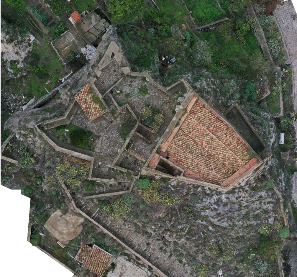
Fig. 6 - Ortomosaico tratto dalla nuvola densa della fotomodellazione del Castello di Scaletta Zancalea. (elaborazione grafica delle autrici, 2024).
