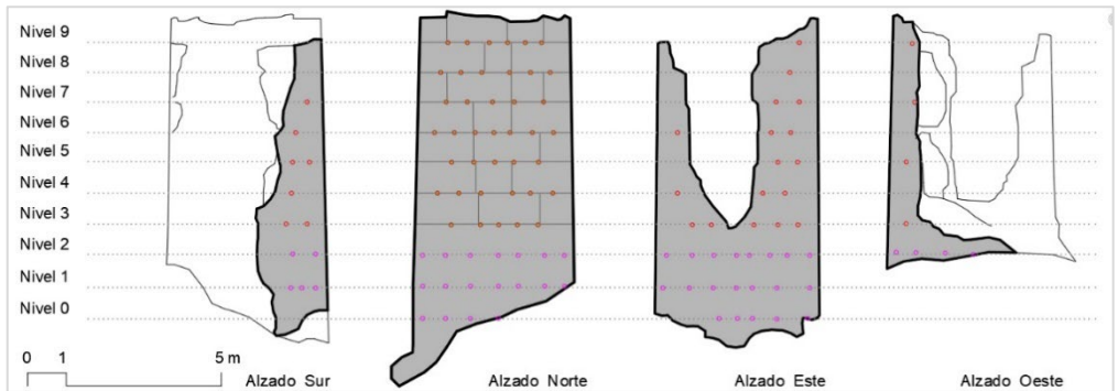
Fig. 6- Alzados de la torre del Villar obtenidos del modelo CAD. Destaca la diferencia de la ejecución de los muros hasta la tapiada tercera respecto el cuerpo superior, con un ritmo y localización distinto en los agujales. Se muestra además las tapiadas del alzado Norte, al ser el único que mantiene todo el paramento. (elaboración gráfica del autor, 2024, a partir de Ruiz y García, 2020).
