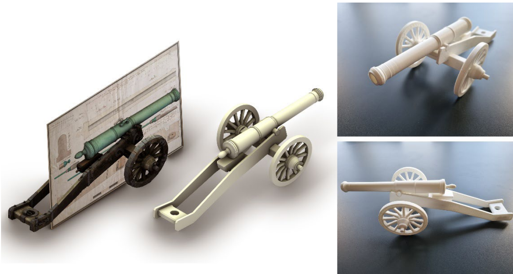
Fig. 2 - A sinistra, processo di reverse-modeling di un cannone tipologicamente affine a quelli previsti per l'armamento del Forte negli anni '30 del XIX sec. A destra, replica fisica ottenuta tramite prototipazione rapida.
