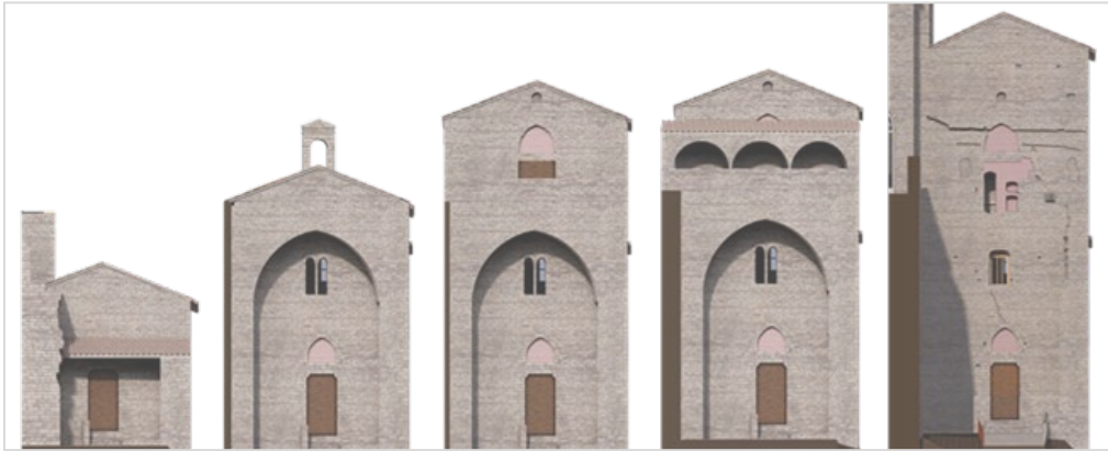
Fig. 8- Comparazione delle fasi storiche mediante software BIM (elaborazione degli autori).
