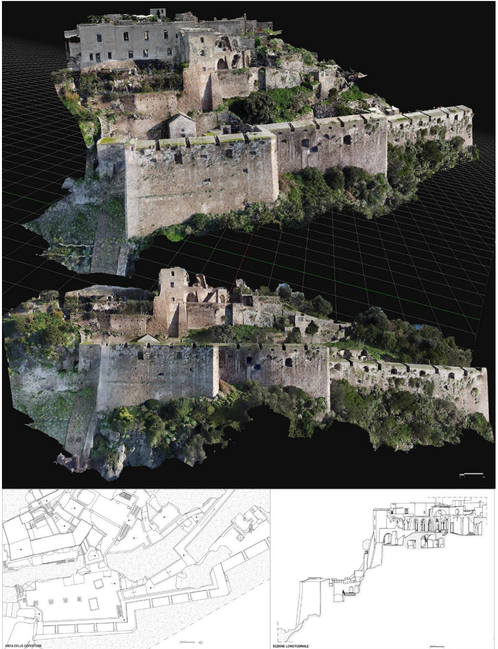
Fig. 4- Dall'alto al basso: modello a nuvola di punti dell'ambito urbano rilevato; ortofoto ad alta risoluzione da modello mesh del versante occidentale; grafici di rilievo della vista dall'alto (a sinistra) e di una sezione trasversale (a destra) (elaborazione e restituzione grafica a cura degli autori, 2024).
