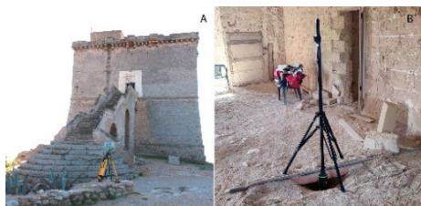
Fig. 3- Fig. 3- Rilievo laser scanner: A) Leica P20 (foto di I. Ferrari, 2018); B) Leica BLK 360 (foto di I. Ferrari, 2024).
